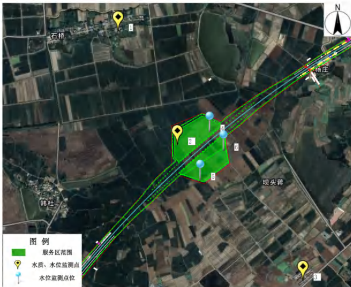
图 4.6.1-2 坝西服务区地下水监测布点
