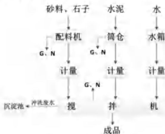
图 3.7.1-4 水稳拌合站工艺流程及产污节点图
